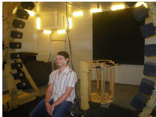
**Abbildung 4.1:** HRTF-Messung in dem semianechoischen Raum der ÖAW
