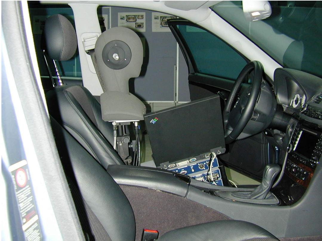
**Abb. 29: Messaufbau Kunstkopfmessung**
