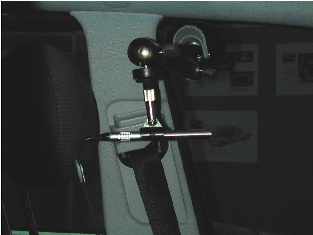
Abb. 30: Messmikrofonaufbau
