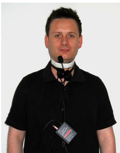
Die Klangbeispiele wurden für die Versuchsreihe mittels eines Headset-Mikrofons mit omnidirektionaler Richtcharakteristik und linearem Frequenzgang aufgenommen. Dazu wurde der Stimmlippenkontakt während der Phonation mit dem EGG-Modul ermittelt. Die beiden Signale wurden über ein Audio-Interface (Tascam US-144 Mk2) auf den Computer (Microsoft Surface
